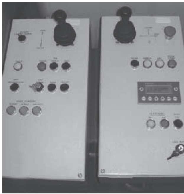
Рис. 4. Элементы сигнализации и управления
