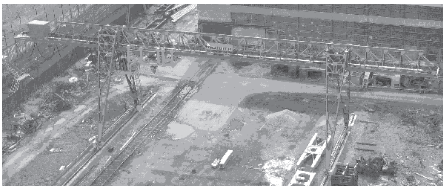
Рис. 1.3. Козловой кран общего назначения
