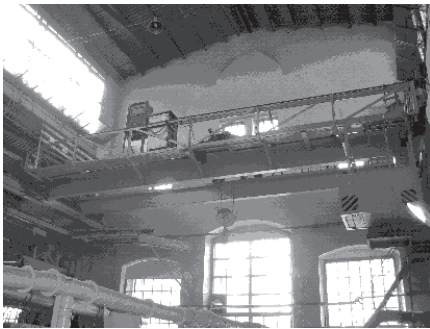
Рис. 1.2. Мостовой кран общего назначения
