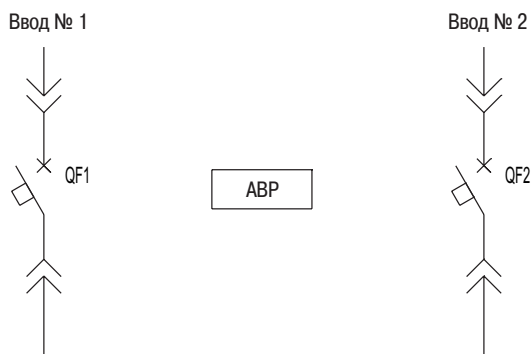
Рис 2.4 Схема «Два ввода на общую систему шин»
