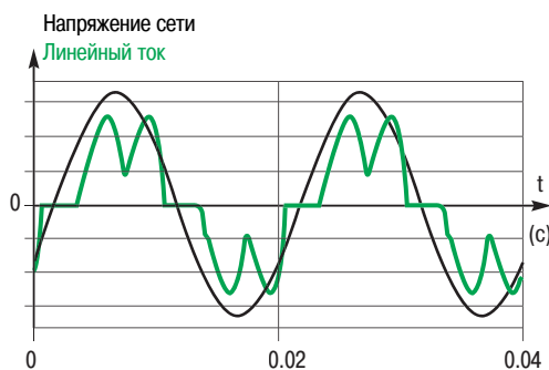
Рис. 6 : потребляемый ток и фазное напряжение сети (трехфазное питание)
