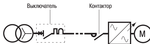
Рис. 13 : защита от перегрузки, встроенная в регулятор, выведена из работы
