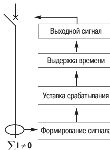
Рис. 16. Функциональная схема работы УЗО
